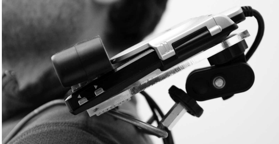
OmniTouch, ein Prototyp von Microsoft Research, verwandelt beliebige Oberflächen in einen Touchscreen.
